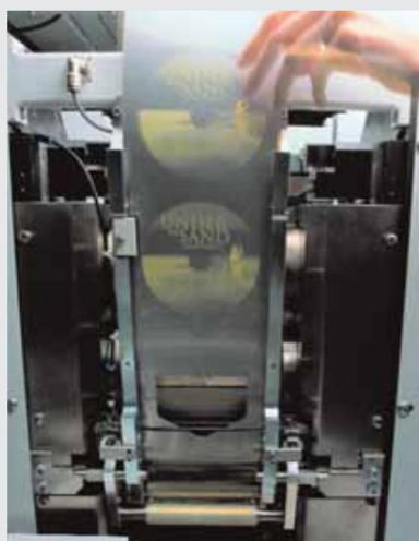
Semiautomatischer, registerhaltiger Druckplattenwechsel innerhalb von fünf Minuten. Es können analoge oder digitale wasserlose Druckplatten eingesetzt werden.
